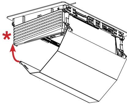
2) Schließen Sie die Vorderseite der Kabelwanne.
