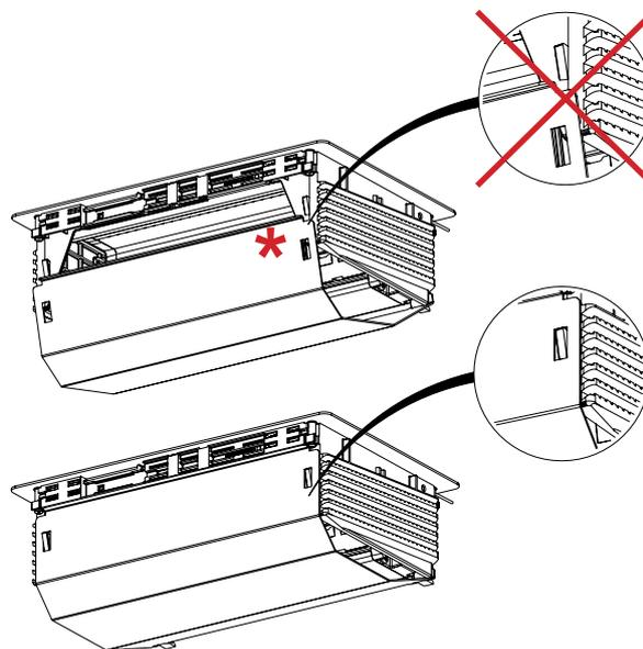
\*) Für einen sicheren Betrieb muss die Kabelwanne am FlipTop Push einrasten.
