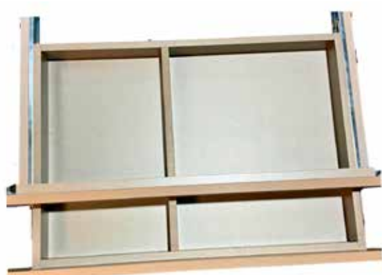
Refuerzo de armazón DM y cajón.
